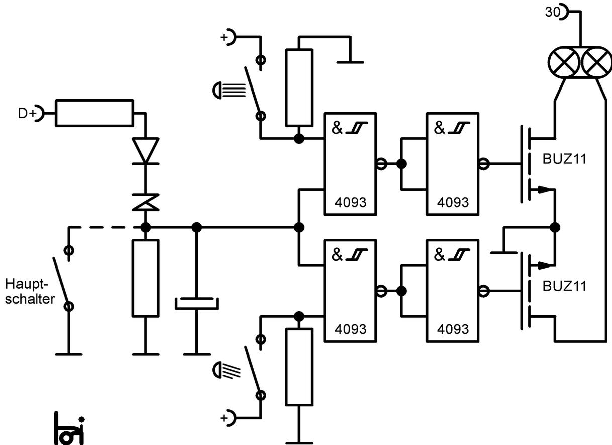
Das Relais schaltet den Minus. Der 'normale Masseanschluss' der H4- Leuchte wird mit Plus (30) verbunden. D+ ist mit dem Generator-Gleichrichter bzw. dem Regler verbunden. Das Licht geht nur, wenn der Generator Spannung liefert und ~10 Sekunden danach. Diese Automatik lässt sich umgehen, wenn D+ an Klemme 15 gelegt wird. Mit dem 'Hauptschalter' kann das Licht permanent ausgeschaltet werden. Die BUZ11 sind, isoliert, auf einem kleinen Alublech montiert.
